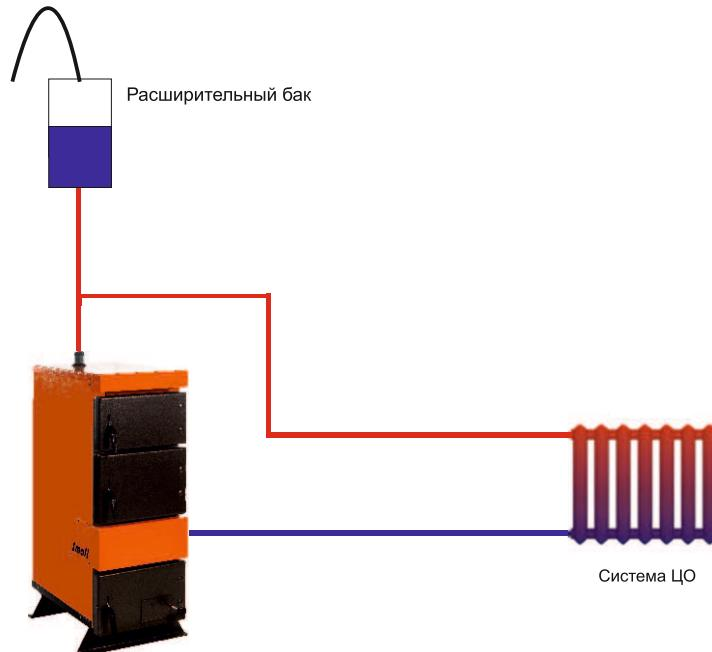
\* Схема подключения (представленная схема является примерной и упрощённой)
