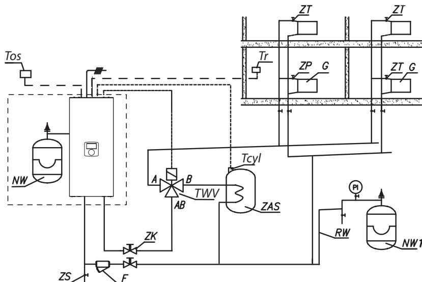
Фильтр необходимо установить так, чтобы направление потока теплоносителя был согласно стрелки указанной на корпусе, а крышка находилась внизу фильтра. Фильтры могут быть установлены в горизонтальных и вертикальных трубах. Рекомендуется использование запорных клапанов непосредственно до и после фильтра, что обеспечивает легкую очистку фильтра или его замену.
