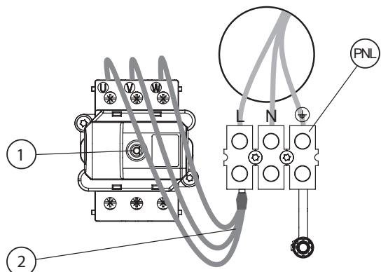
Для подключения к трехфазной электрической сети (для котлов мощностью 4, 6, 8 кВт) необходимо отсоединить провода ② и переключить переключатель №3 в положение ON стр. 7)
