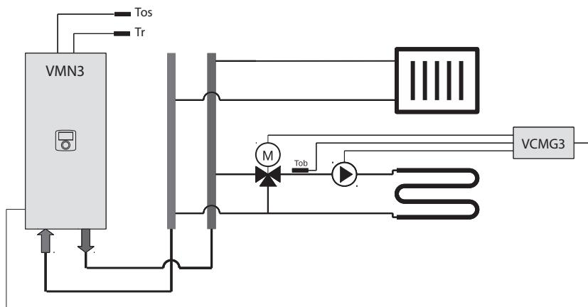
Управляемый модулем контур отопления нагревается согласно настроенной на котле временной программы, но с собственной кривой отопления или ручными настройками.
