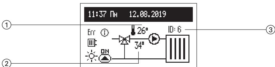
На экране представлены подачи контура отопления ①, заданная температура в контуре ②, а также идентификатор контура отопления
